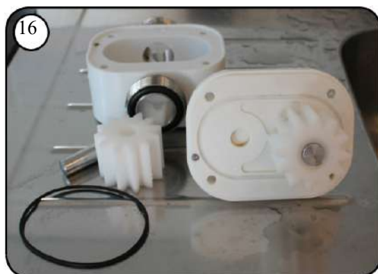
La carcasa de la bomba debe limpiarse lavándola en un lavavajillas (programa normal) o lavándola a mano en agua tibia y detergente.
