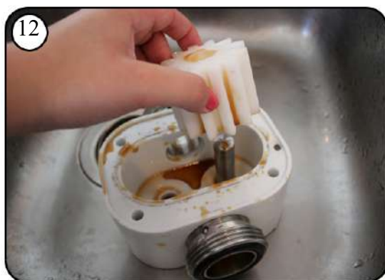
Retire el engranaje y el eje que todavía está en el cabezal de la bomba. Puede ser necesario enjuagar con agua para aflojarlo.
