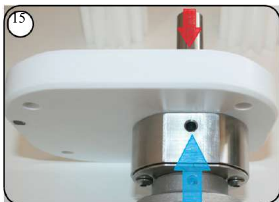
Lavar con agua a lo largo del eje (flecha roja) para que el agua entre en el sellado. A veces puede suceder que una pequeña cantidad de la sustancia de bombeo / limpieza saldrá de dibujo (flecha azul) pero eso está bien.
